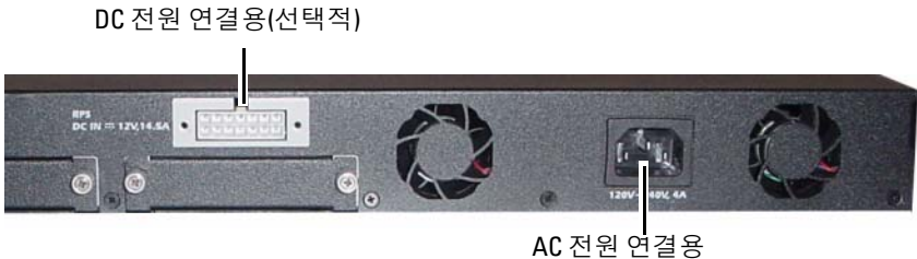
그림 1-15. 스위치에 AC 및 DC 전원 연결
