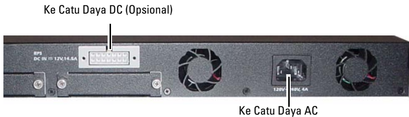
Gambar 1-15. Hubungan Daya AC dan DC ke Switch
